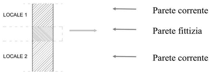
22. **ponte termico** è la discontinuità di isolamento termico che si può verificare in corrispondenza agli innesti di elementi strutturali (solai e pareti verticali o pareti verticali tra loro).
